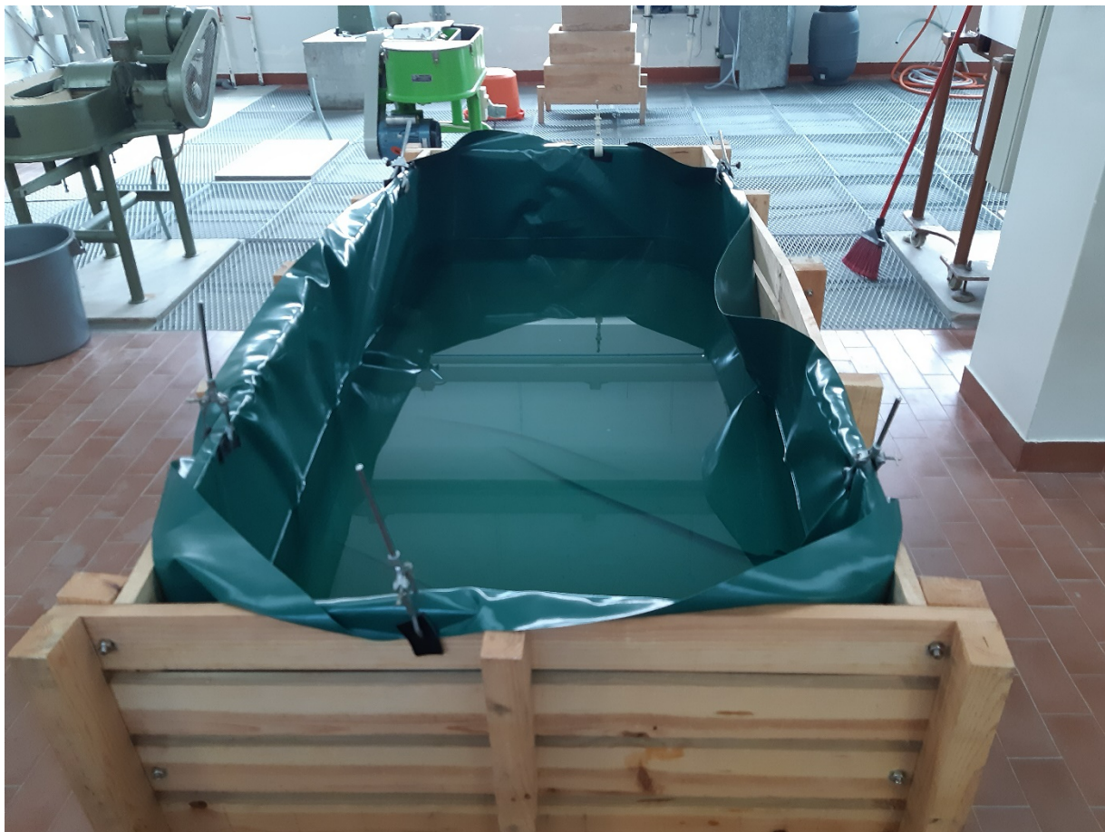
Fig. 6.4 – Estrutura modular da ZHC, com elementos de madeira, em preparação no Laboratório Tecnológico do IPT.
