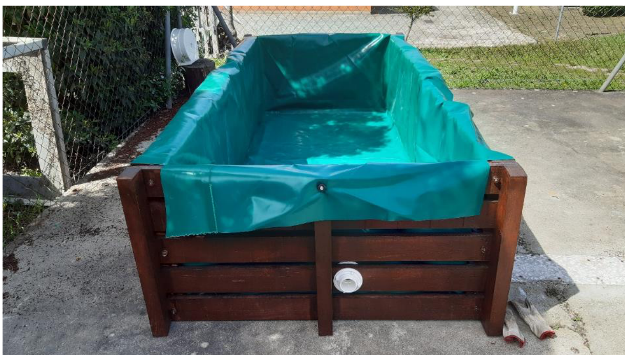
Fig. 6.8 – Realização de testes de estanquicidade da tela de impermeabilização.
